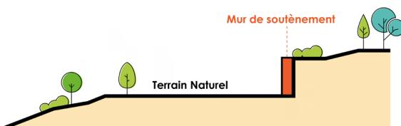
Le mur de soutènement est un mur qui permet de contenir les terres du terrain naturel.
