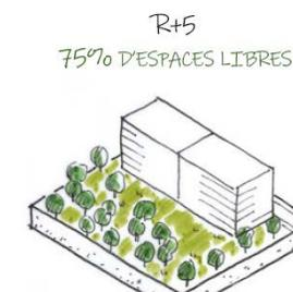
^ Assumer une hauteur plus importante pour dégager les sols : à surface de plancher constante, accroître la hauteur du bâti permet d'obtenir des espaces verts généreux.
