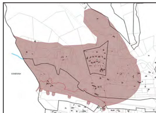
Figure 18 : risque minier aléa effondrement localisé lié aux travaux souterrains
