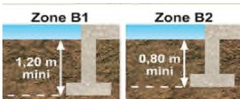
\* sur terrain en pente et pour les constructions réalisées sur plate-forme en déblais ou déblais-remblais, ces fondations doivent être descendues à une profondeur plus importante à l'aval qu'à l'amont afin d'assurer une homogénéité d'ancrage,
